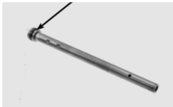
Posicione o cilindro interno sobre blocos em V e meça seu empenamento com um relógio comparador.
