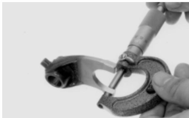
Verifique se o eixo dos garfos seletores está empenado, desgastado ou danificado.
