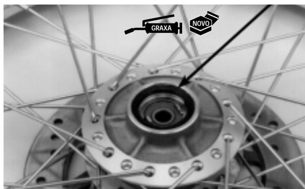
Instale a caixa de engrenagens do velocímetro no cubo esquerdo da roda, alinhando suas lingüetas com os recortes.
