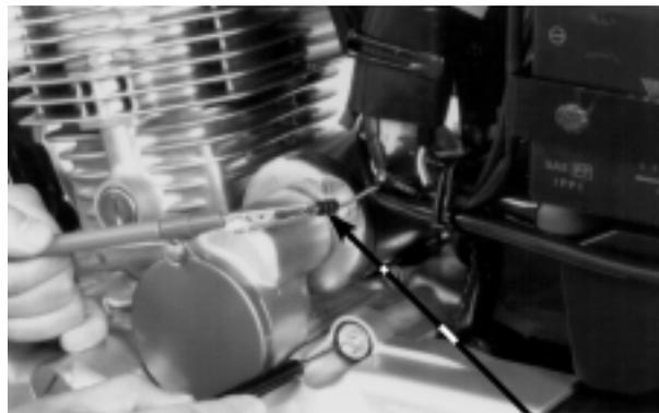
CONECTOR DO GERADOR DE PULSOS DA IGNIÇÃO
