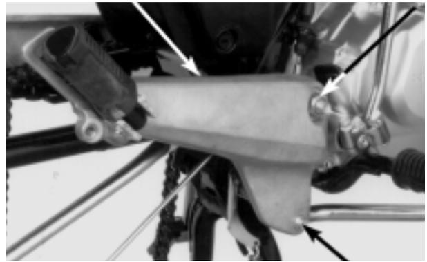
Remova o parafuso de fixação do suporte do pedal de apoio esquerdo do passageiro.
