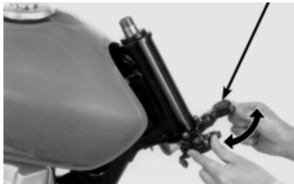
Solte provisoriamente a porca de ajuste da coluna de direção e, em seguida, reaperte-a no torque especificado.
