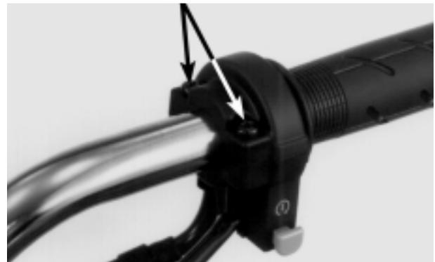
Instale o cilindro mestre e seu suporte com a marca "UP" virada para cima.
