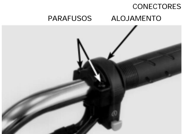
Solte o cabo do acelerador da manopla do acelerador. Em seguida, remova a manopla.
