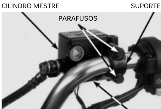
Remova os parafusos e separe o alojamento do interruptor do guidão direito/acelerador.
