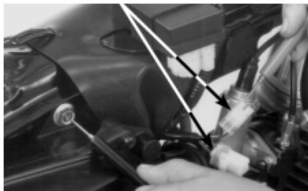
Solte o conector da bobina de excitação do alternador e conecte a ponta de prova do testador no terminal Preto/Vermelho e no terra. Meça o pico de voltagem da mesma forma que foi medida no conector do ICM. Compare-a com a voltagem medida no conector do ICM.
