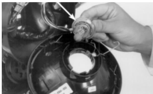
**REMOÇÃO/INSTALAÇÃO DA CARÇAÇA DO FAROL**
