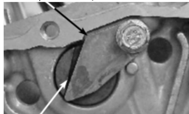
Contato deficiente entre o ressalto do eixo e a face de apoio da placa limitadora
