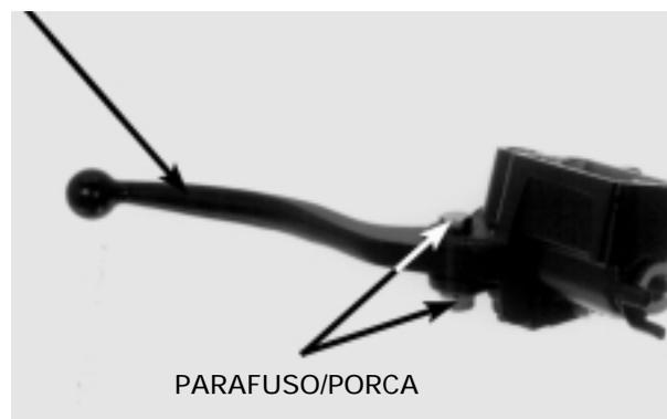
Remova o parafuso e o interruptor da luz de freio.
