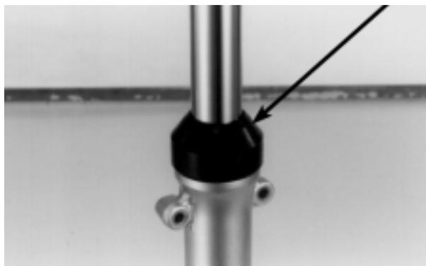
Adicione a quantidade especificada do fluido para suspensão recomendado no cilindro interno.
