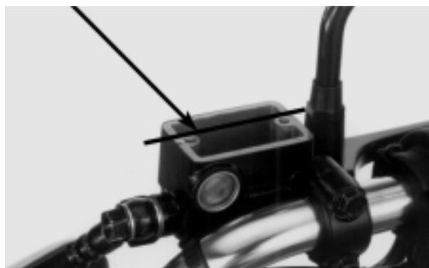
Instale o diafragma, a placa de fixação e a tampa do reservatório. Aperte os parafusos no torque especificado.
